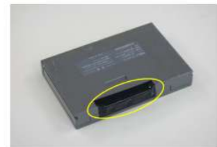
（電極端子部の被覆）
