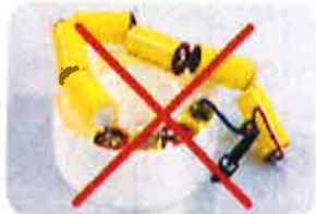
電池パックから外れかけた連結電池
